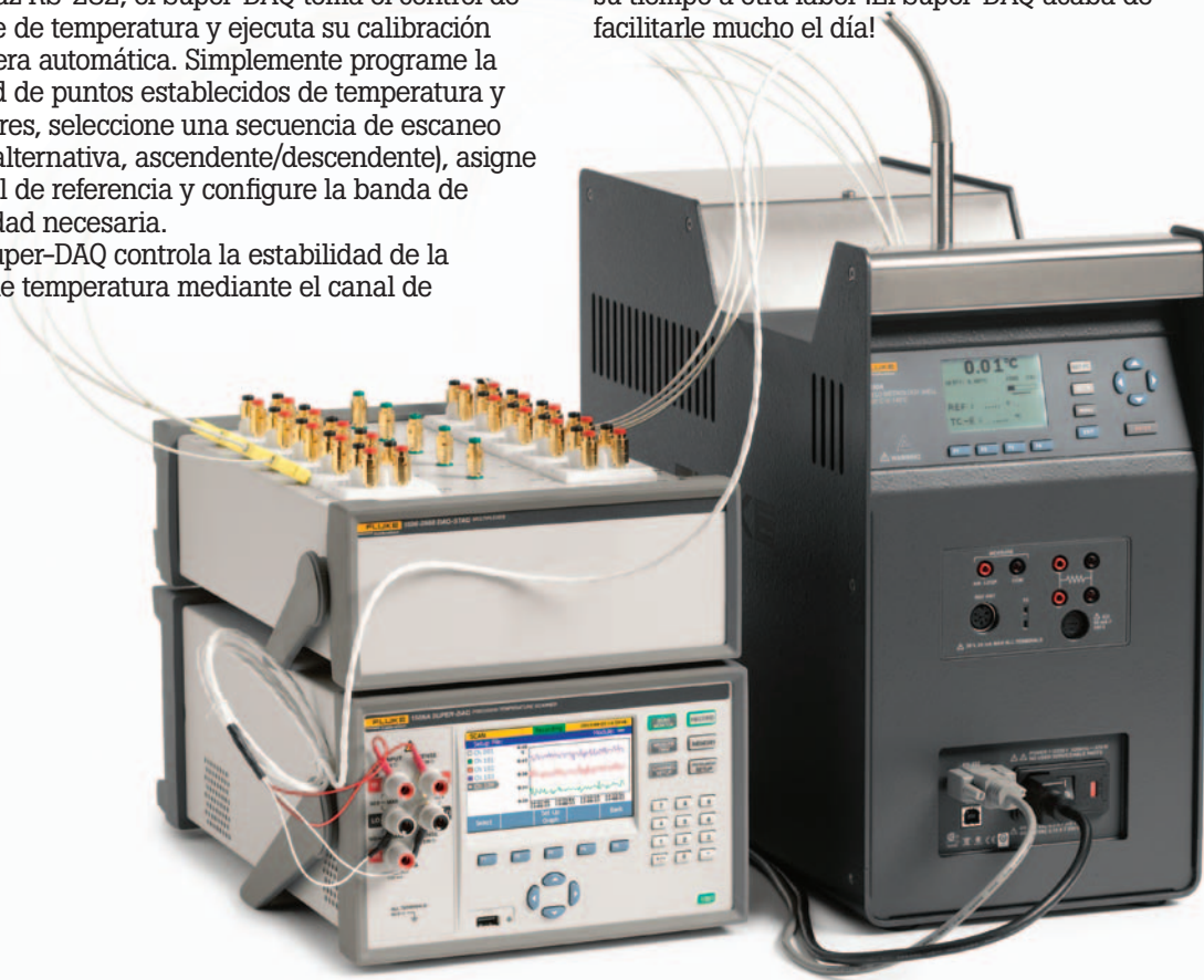
1586A configurado con un DAQ-STAQ y un Pozo de metrología de campo ultra frío 9190A para la calibración automática de sondas.
